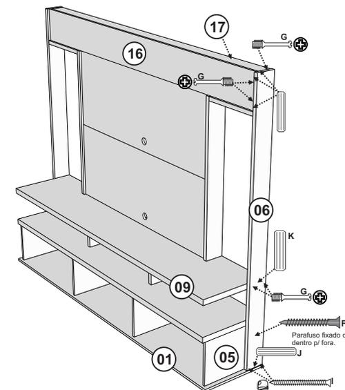
Fixar a peça 06 na peça 01 com Parafuso 5x50 c/ bucha e Cavilha.
