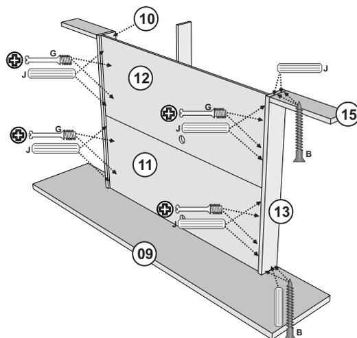
Fixar a peça 11 e 12 na peça 10 e na peça 13 com Cavilha e MiniFix.
