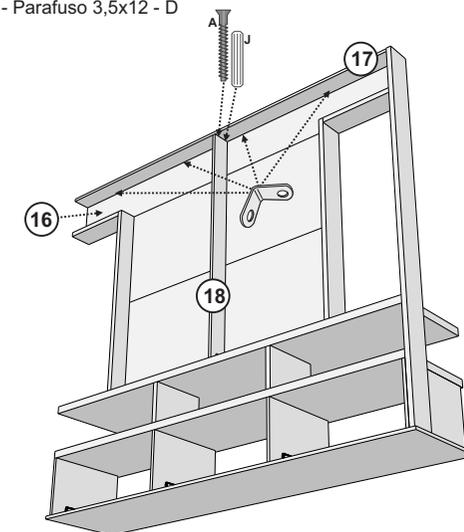
Fixar a peça 17 na peça 16 com Cantoneira Metálica e na peça 18 com Cavilha e Parafuso 5x50 c/ ponta.
