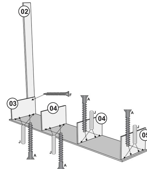
Fixar as peças 03, 04 e 05 na peça 01 com Cavilha e Parafuso 5x40. Fixar a peça 03 na peça 02 com Parafuso 5x35.
