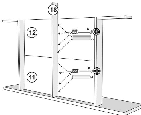
Fixar as peças 11 e 12 nas peças 18 com Cavilha e MiniFix 15mm.
