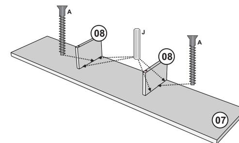
Fixar as peças 08 na peça 07 com Parafuso 5x40 e Cavilha.
