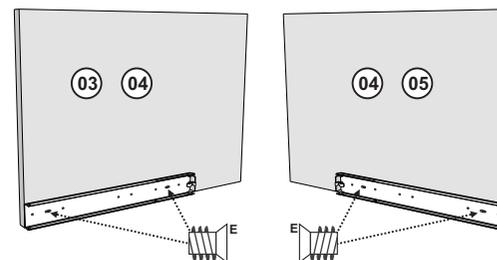
Fixar as Corredeira Telescópicas rente as peças 03, 04 e 05 com Parafuso 6x8, conforme ilustração a cima.
