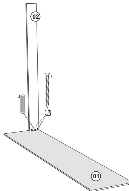
Fixar a peça 02 na peça 01 com Parafuso c/ bucha e Cavilha
