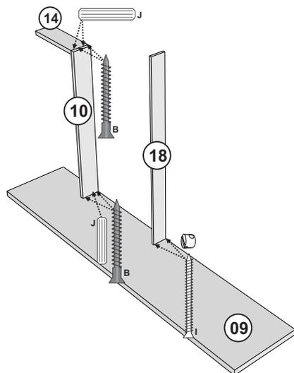
Fixar a peça 18 na peça 09 com Cavilha e Parafuso 5x50 c/ bucha.
