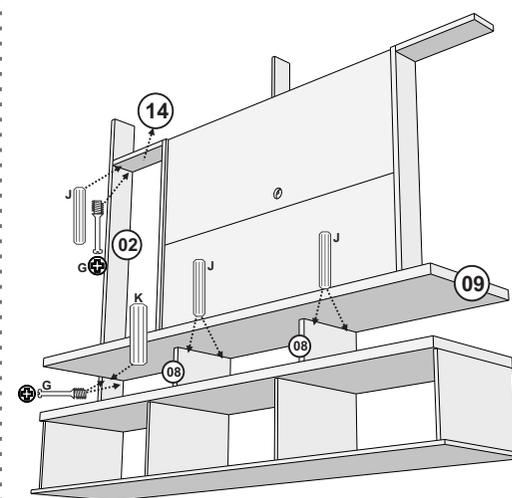
Fixar a peça 09 nas peças 08 e na peça 02 com Cavilha e MiniFix e na peça 02 com MiniFix e Cavilha 8x30.
